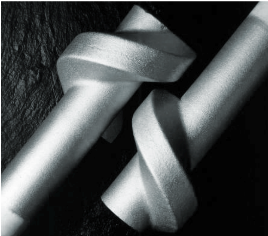
Platinbeschichteter Keramikrührer für den Einsatz bei der Glasherstellung
