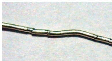
Bild 1: Platindraht zeigt Bambusstruktur nach zu langem Erhitzen auf sehr hohe Temperaturen
